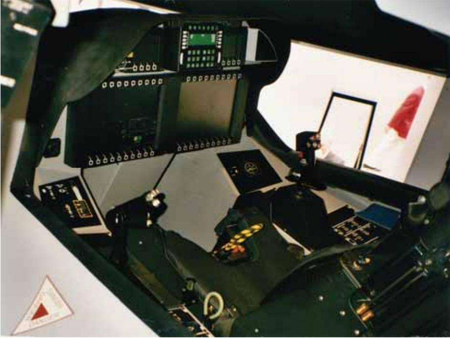
الشكل (41.2): أجهزة مقصورة الطيار التوضيحية لبوينغ X32 JSF. وكل من شاشتي عرض الرأس المنخفض الأساسية يمكن تقسيمها إلى أربع نوافذ بالتفعيل الصوتي.
