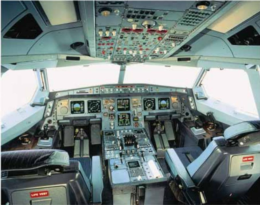
الشكل (4.1): سطح الطيران للطائرة إيرباص A340 (بترخيص من شركة Airbus).
